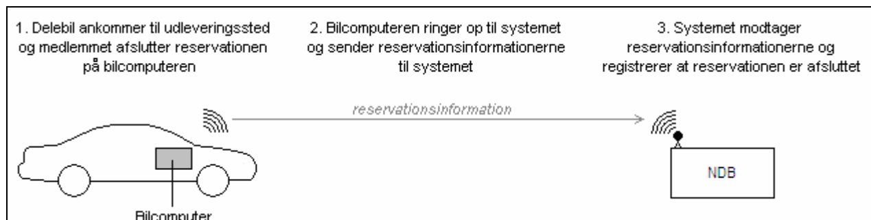
Figur 4.2: Overførsel af data fra delebil til IT-systemet, til registrering af aflevering.
